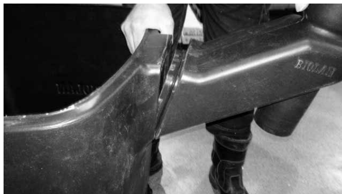
Kuva 1 Asenna tuuletuskanava (osa 7) paikalleen runko-osaan.
